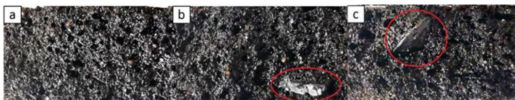
Rys. 1. Kompozyty olejowe: a) bez dodatku naturalnego i z zawartością 6% b) łupiny orzecha włoskiego c) łupiny pistacji.
