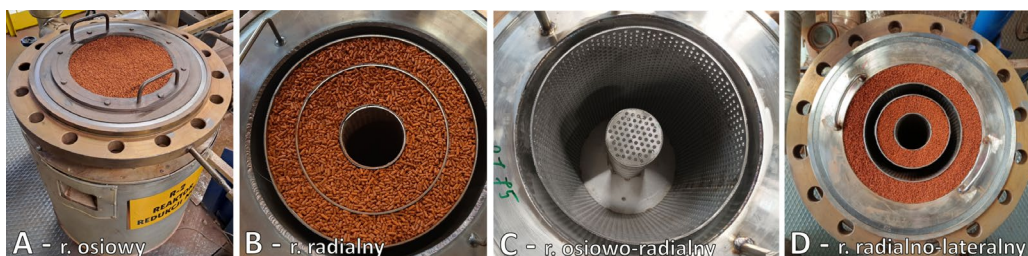
Rys. 1. Konstrukcje koszy katalitycznych, stosowane podczas badań katalizatora SCR-deNO x w reaktorze SCR w pilotowej instalacji kwasu azotowego Łukasiewicz - INS
