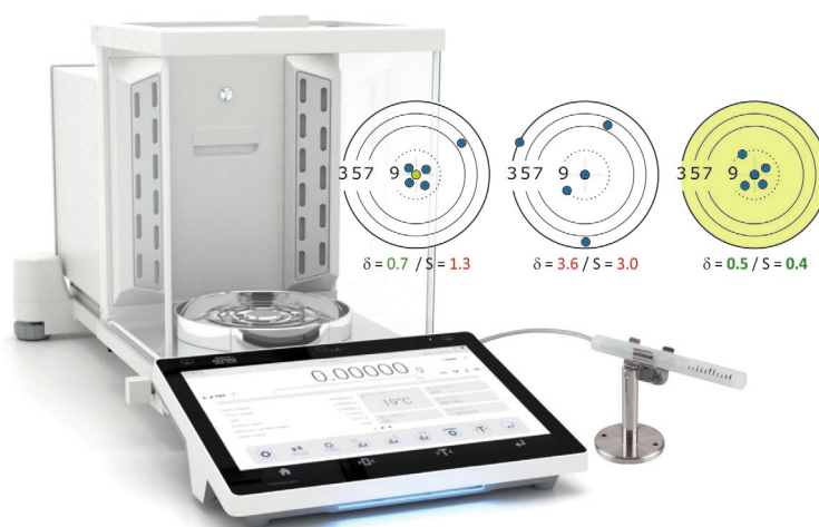
Rys. 1. Metrologia pomiarów masy - waga XA 82/220.5Y
